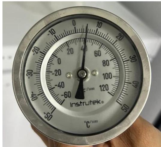
*Ilustración 4. 1 Termómetro patrón. Fuente: fotografía propia, 2024.*
